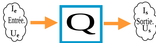
Représentation schématique d'un étage sous forme d'un quadripôle
